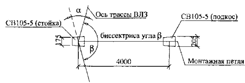
Схема установки стойки и подкоса
