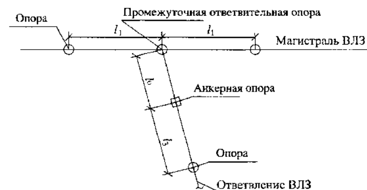
Схема отвлечения от ВЛ на промежуточной опоре П20-3Н
